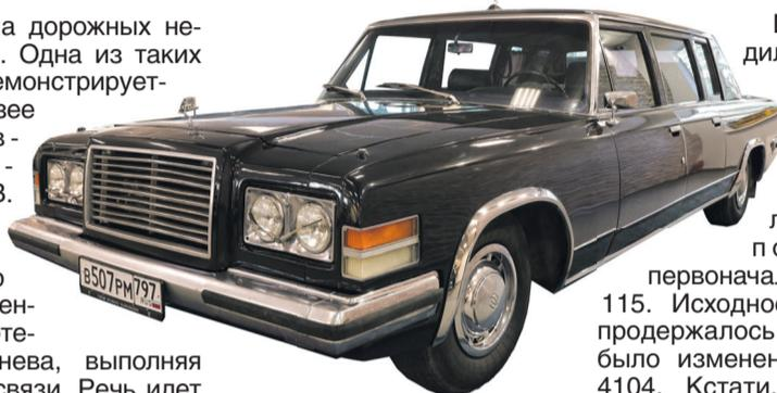
бронированном варианте ЗИЛ-115 одно дверное стекло весило порядка 40 кг, то начинаешь смотреть на них иначе. Бензиновый восьмицилиндровый V-образный двигатель рабочим объемом 7,7 л развивает мощность 315 л.с. Коробка передач трехступенчатая, оснащенная механическим стопором для удержания машины на уклоне, который сам убирается при начале движения. Рулевой механизм – с гидроусилителем и возможностью изменять высоту руля. Яркое сви-
