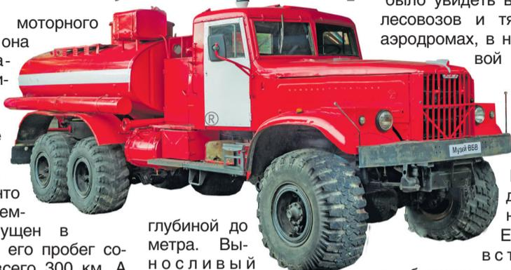
глубиной до метра. Выносливый мотор отличался хорошим аппетитом и «всеядностью» – годились и солярка, и авиационный керосин, и даже топливные отходы.
