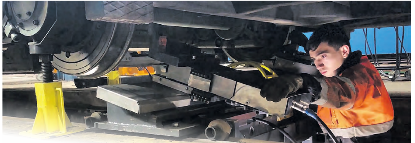
Обточка колес с помощью зеленоградского станка
