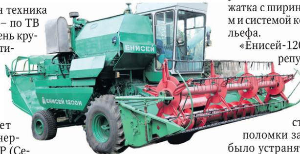
ведущий мост заимствован у трактора Т-150К, а управляемый оснащен колесами с шинами повышенной ширины для снижения давления на почву. Гидрообъемный привод обеспечивал плавное управление и повышенную маневренность в условиях грязи. В движение (со скоростями 1,9 и 5,6 м/с) аппарат приводился дизелем СМД-22 (120-140 л.с.) или более мощным двигателем ЯМЗ-236 (до 185 л.с.), способными работать на низкокачественном топливе. Двухбарабанная молотилка с регули-
